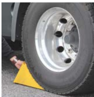
Abb. 1-14 Sicherung des Fahrzeugs mit Unterlegkeilen
