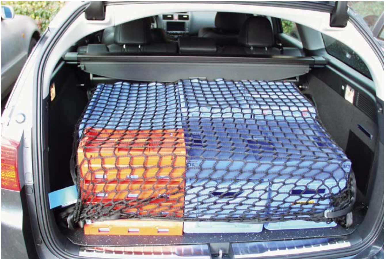
Abb. 10-1 Ladungssicherung im Pkw mit Hilfe eines Sicherungsnetzes
