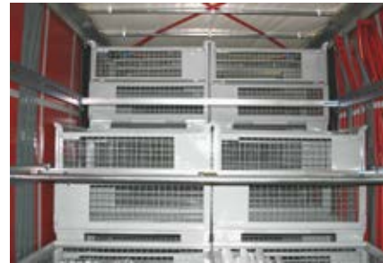
Abb. 7-11 Sicherungsprinzip: Der Fahrzeugaufbau und die Hilfsmittel zur Ladungssicherung (hier z. B. Sperrbalken) müssen die erforderlichen Sicherungskräfte aufnehmen können.
