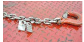
Abb. 6-24 / 6-25 Diese Ketten haben einen zweiten Anhänger mit Prüfdatum
