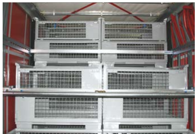
Abb. 10-30 Blockieren mit Sperrbalken
