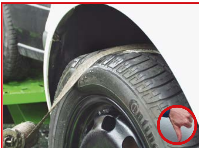
Abb. 10-107 Falsche Gurtführung: Reifen kann Schaden nehmen
