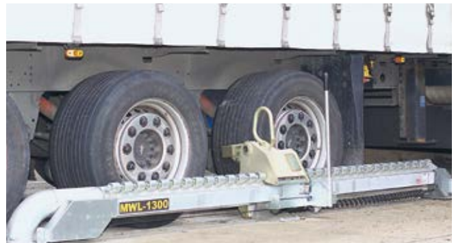
Abb. 2-15 Manuelle Verriegelung zur Sicherung des Lkw
