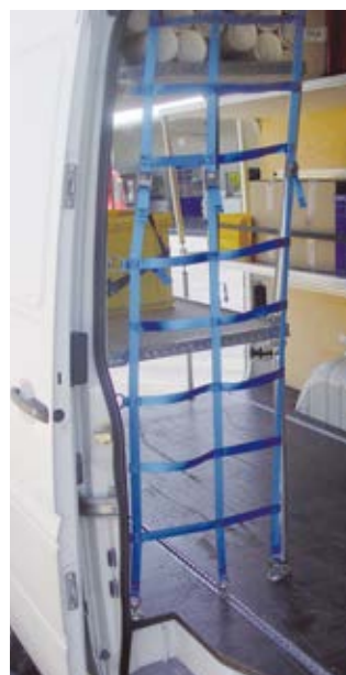
Abb. 6-50 Ein Gurtnetz bildet den gesamten Regalabschluss
