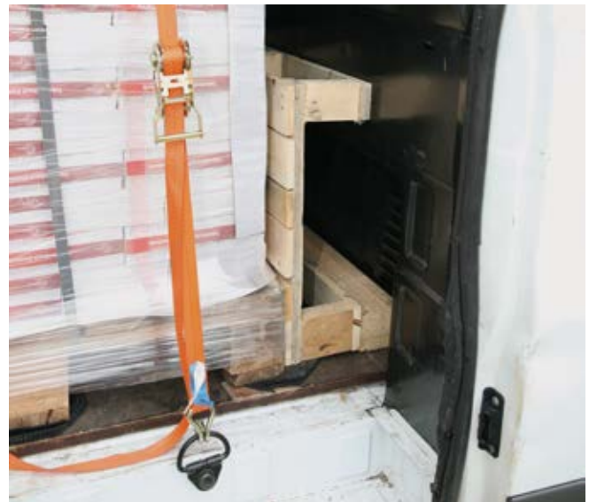
Abb. 6-1 Niederzurren mit einem Zurrgurt
