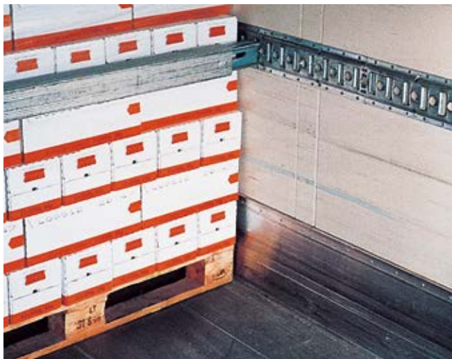
Abb. 6-60 Beispiel: Ankerschienen dienen der Aufnahme von Sperrbalken.
