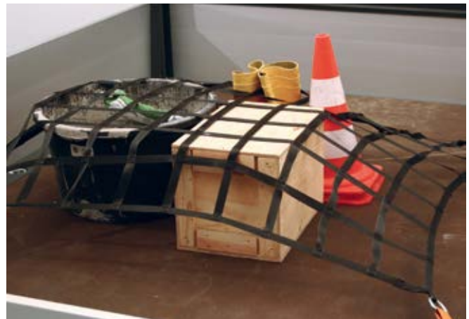
Abb. 10-23 Sehr gut einsetzbar: Zurrnetz
