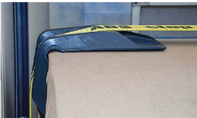
Abb. 6-16 Die Hohlkehle verhindert eine Beschädigung des Ladeguts.
