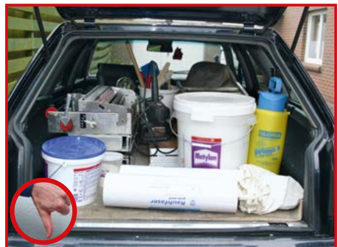
Abb. 10-7 Ungesicherte Ladung gefährdet Insassen
