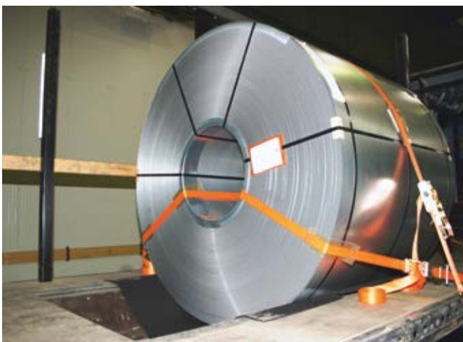
Abb. 10-64 Zurrmittel zur rückwärtigen Sicherung nach vorn abspannen
