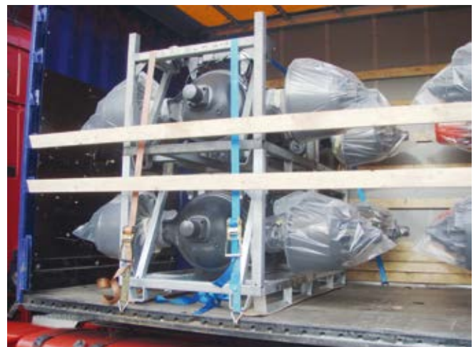
Abb. 10-55 Sicherung von Ladungsträgern durch Niederzurren
