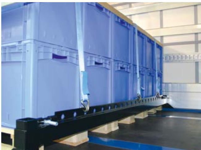
Abb. 10-56 Sicherung durch Blockieren und Zurren
