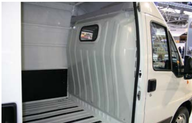
Abb. 10-10 Trennwand schützt die Insassen
