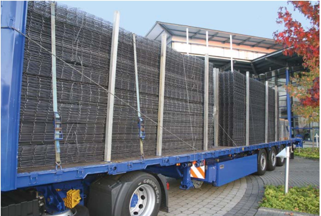
Abb. 10-74 Formschluss durch Steckungen
