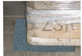
Abb. 3-10 Anti-Rutsch-Material zwischen Trailerboden und Palette.
