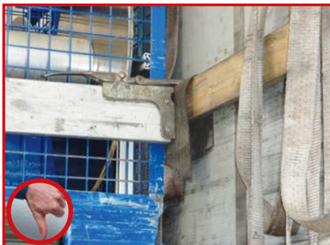
Abb. 10-57 Kann nur wenig Kraft aufnehmen: Klemmbrett
