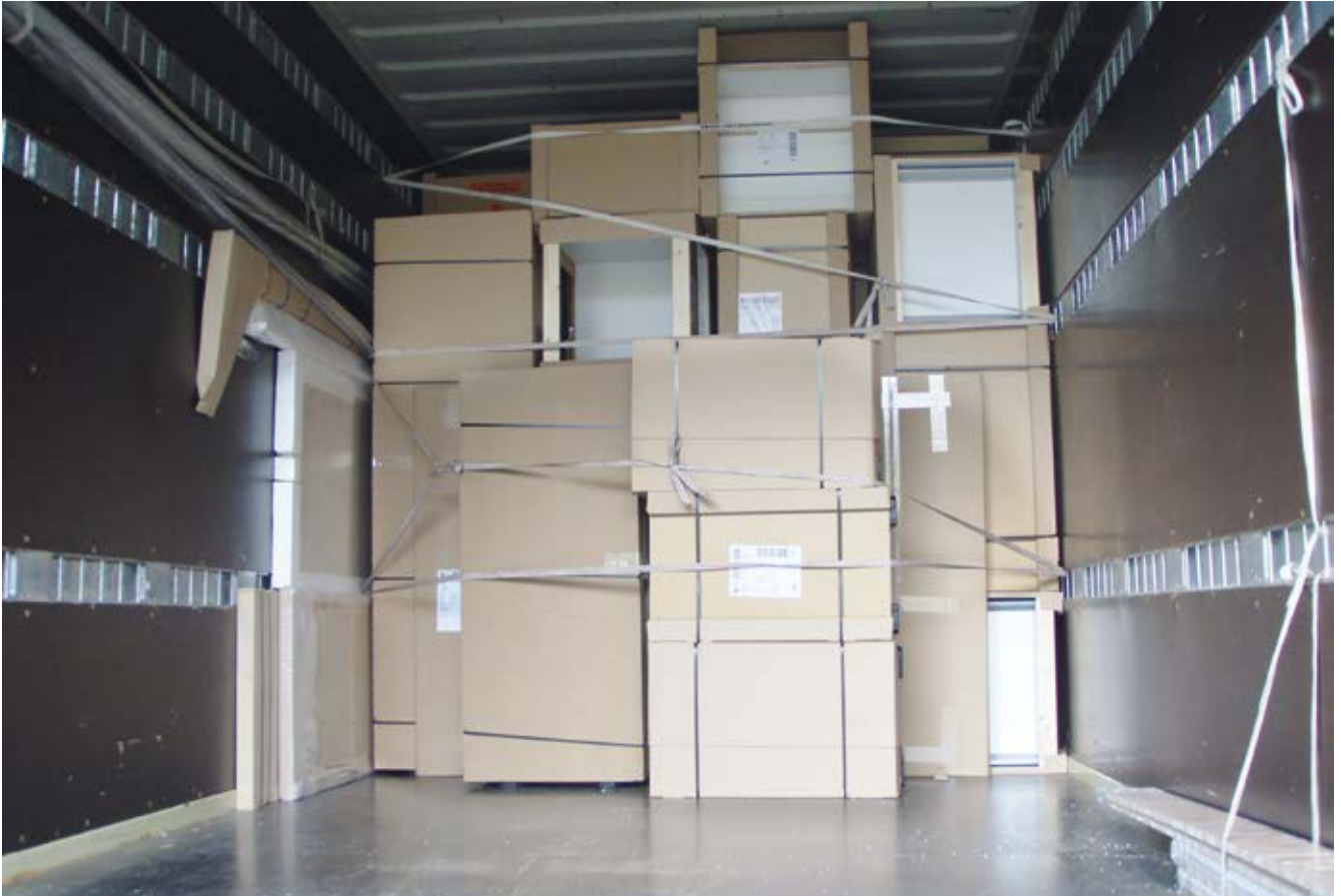
Abb. 10-46 Sicherung durch Direktzurren mit Gurtbändern
