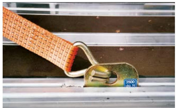
Abb. 5-29 Rungentaschenreihe mit Zurrloch; Belastung Zurrlöcher 2.000 daN
