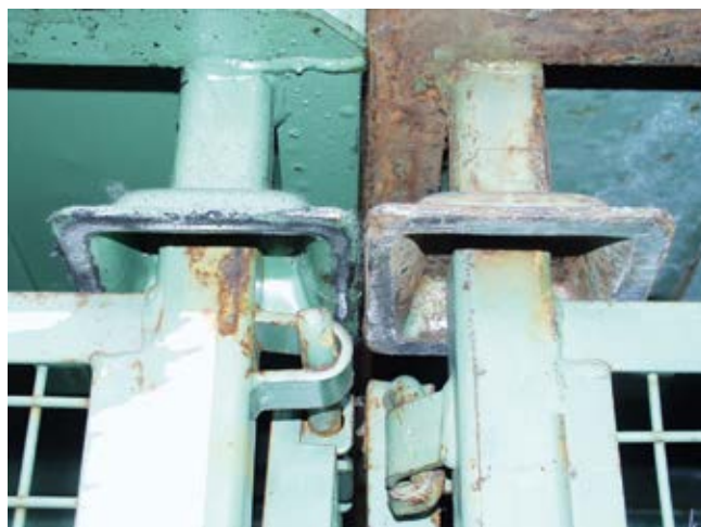
Abb. 10-58 Hier formschlüssig gestapelt: Gitterboxen
