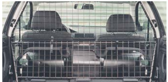
Abb. 6-46 Nachträglich eingebautes Trenngitter nach DIN 75410-2
