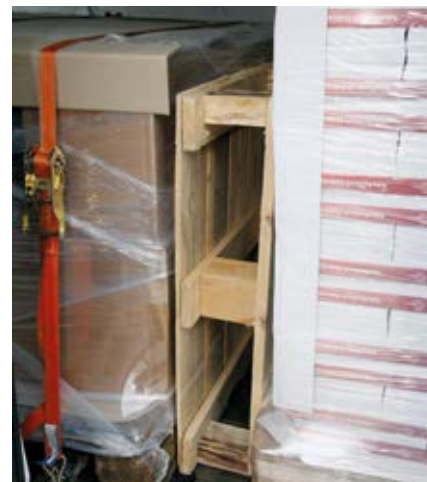
Abb. 7-13 Eine Leerpalette sichert die Ladelücke.
