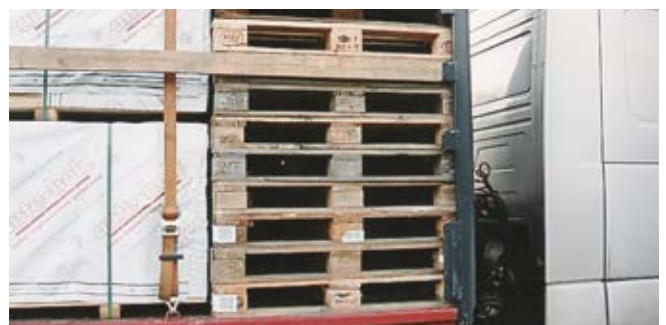
Abb. 6-67 / 6-68 Leerpalletten können stehend oder liegend eingesetzt werden.
