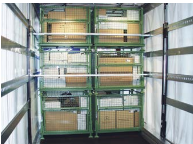
Abb. 10-54 Blockieren mit Sperrbalken
