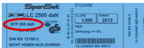
Abb. 8-36 Zurrgurtetikett eines Zurrgurts mit einer S_{TF} von 350 daN
