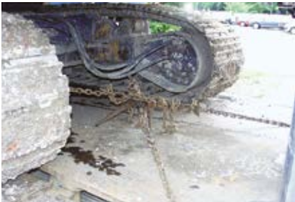
Abb. 7-48 Ladungssicherung durch Diagonalzurren
