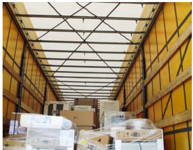
Abb. 5-15 Code XL-Fahrzeugaufbau (mit Dachverstrebungen zur Aussteifung)
