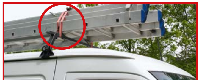
Abb. 5-6 Dachträger müssen fest mit dem Fahrzeug verbunden sein, so dass die im Fahrbetrieb auftretenden Massenkkräfte aufgenommen werden können. Bei der Beladung des Dachträgers sind die Belastbarkeit des Trägers, die zGM, die Achslasten sowie die Belastbarkeit der Befestigungspunkte des Fahrzeugs zu beachten. Achtung: Auf den Gesamt-schwerpunkt achten. Anm.: Leitern sollten auf einem Dachträger direkt an der Strebe festgezurt werden. Das auf dem Foto gezeigte Niederzurren ist keine geeignete Art der Ladungssicherung!
