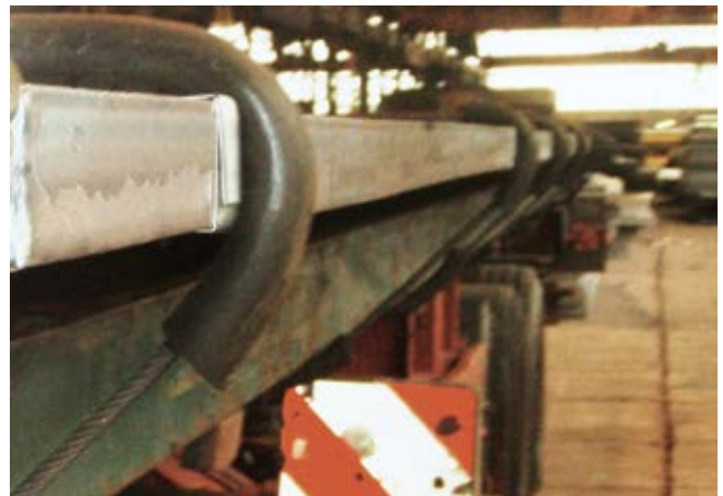
Abb. 10-72 Konsequenter Einsatz von Kantenschutzmitteln
