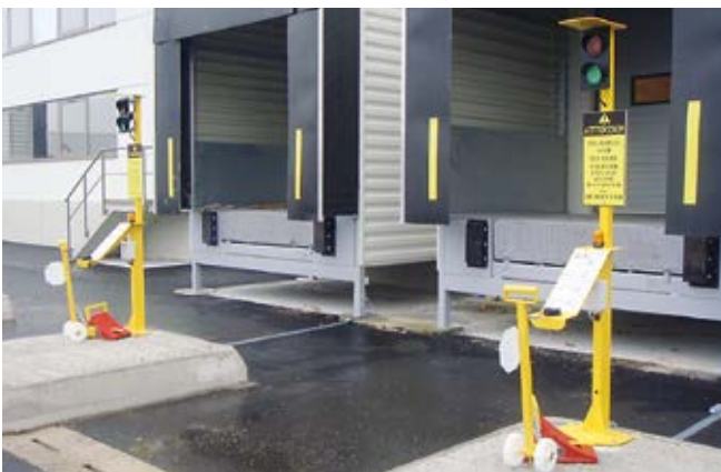
Abb. 2-14 Elektronischer Unterlegkeil mit Ampelsteuerung
