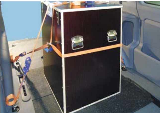
Abb. 10-4 Kombination aus Kopfschlinge, Niederzurren und RHM
