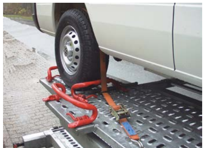
Abb. 10-105 Drei-Punkt-Zurrgurt in Kombination mit Radvorlegern
