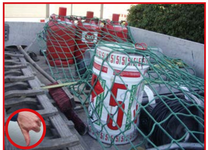
Abb. 10-24 Oft falsch angewendet: Abdecknetz
