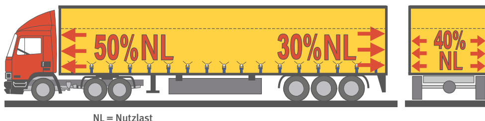
Abb. 5-22 Verstärkter Aufbau „Code XL“ (für 3/4 der Höhe bei einer Stirnwandhöhe > 1,60 m)
