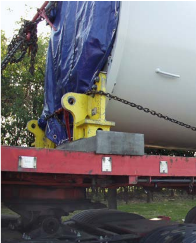
Abb. 7-35 / 7-36 Praxisbeispiele für das Kopfschlingenzurren
