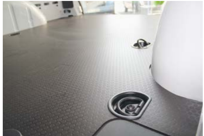
Abb. 5-8 Detailaufnahme eines im Boden eingelassenen Zurpunkts
