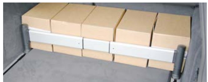
Abb. 6-47 Schienensystem im Gepäckraum für Teleskopstangen
