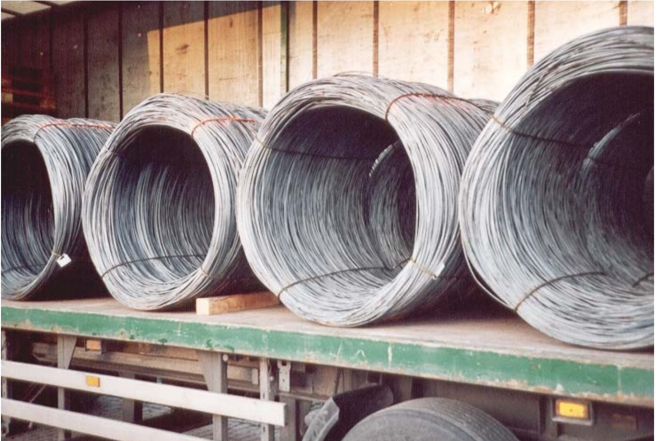
Abb. 10-81 Formschluss. Hinweis: Muss noch gegurtet werden!
