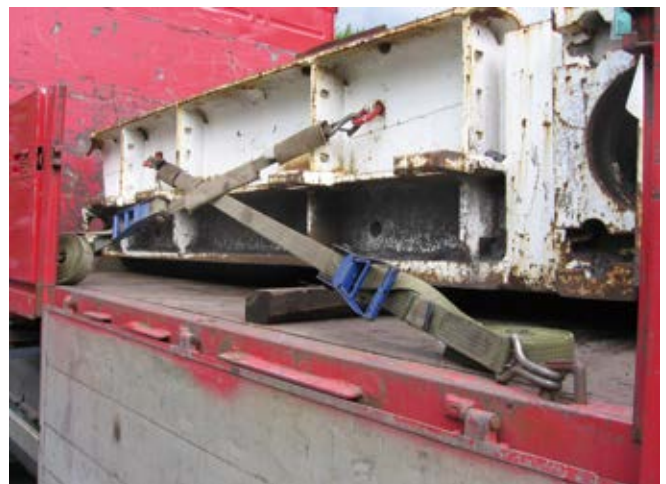
Abb. 7-29 bis 7-31 Praxisbeispiele: Diagonalzurren schwerer Bauteile oder Maschinen
