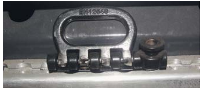
Abb. 5-28 Zurrschienensystem mit Rasterabstand
