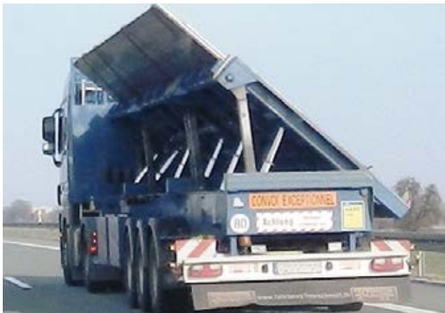
Abb. 10-70 Überbreite Bleche auf einem Schrägbock
