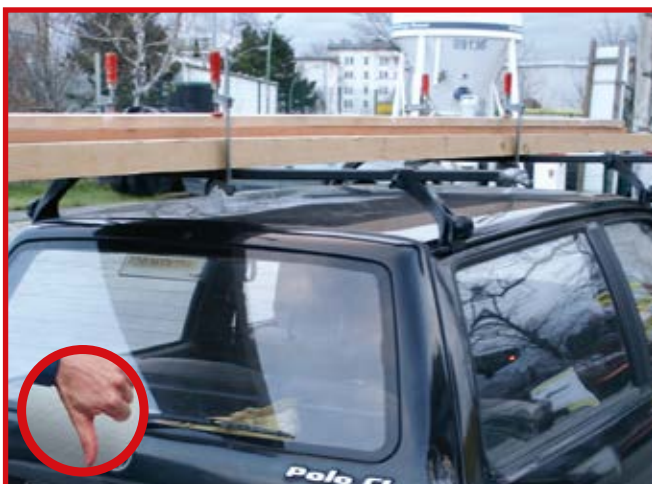
Abb. 10-5 Schraubzwingen sind keine Ladungssicherungshilfsmittel
