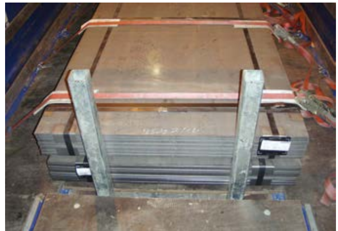
Abb. 10-101 Formschluss in Fahrtrichtung durch Steckungen
