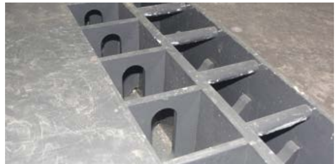
Abb. 5-29 Rungentaschenreihe mit Zurrloch; Belastung Zurrlöcher 2.000 daN
