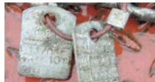
Abb. 6-24 / 6-25 Diese Ketten haben einen zweiten Anhänger mit Prüfdatum
