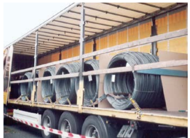
Abb. 10-87 Jede Rolle mit zwei Kopfschlingen sichern
