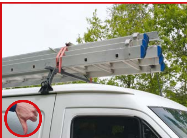
Abb. 10-22 Hier nicht geeignet zur Ladungssicherung: Niederzurren
