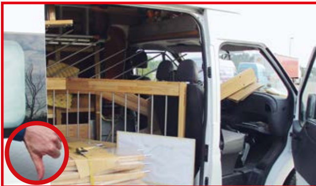
Abb. 10-8 Risikotransport für die Insassen; Transporter ohne Trennwand
