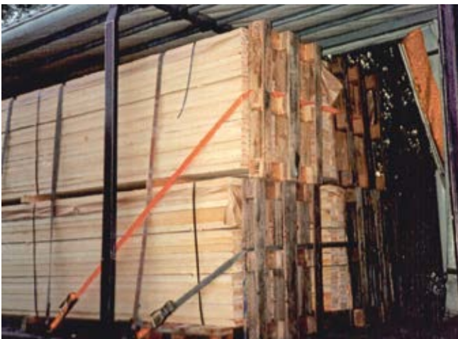
Abb. 10-29 Kopfschlinge mit Zurrgurten
