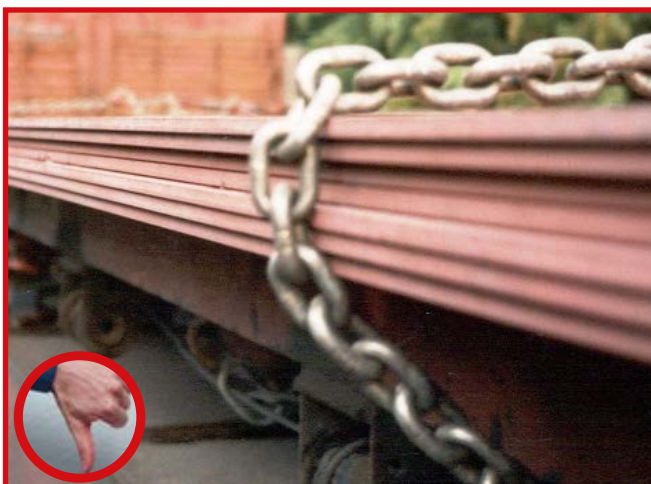
Abb. 10-71 Kettenglieder bleiben an Kanten hängen
