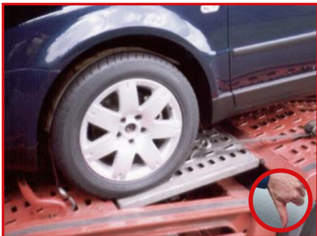
Abb. 10-106 Falsche Position: Radvorleger kann Rad nicht blockieren
