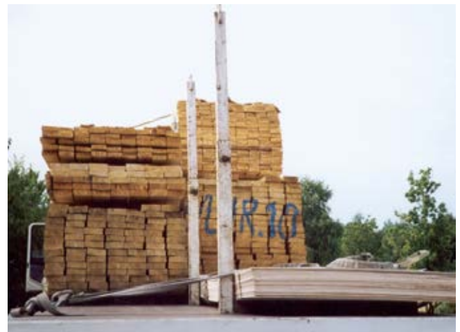
Abb. 10-31 Fixieren durch Mittelrungen
