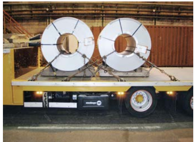
Abb. 10-62 Coils auf Palette – durch Schlingenzurren gesichert
