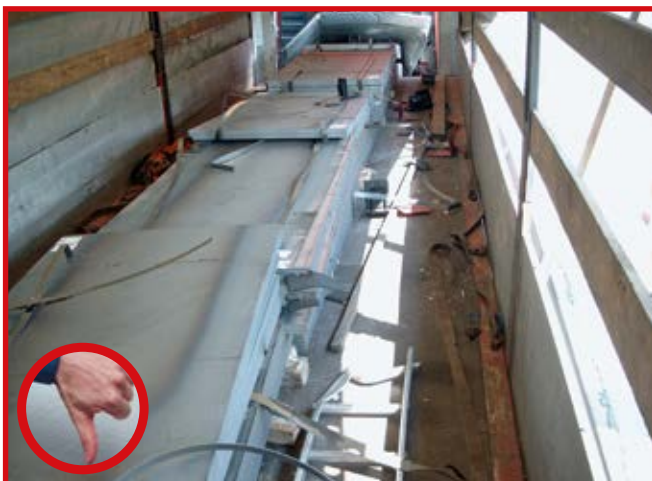
Abb. 10-100 Durch Vollbremsung zerstörte Ladeeinheiten
