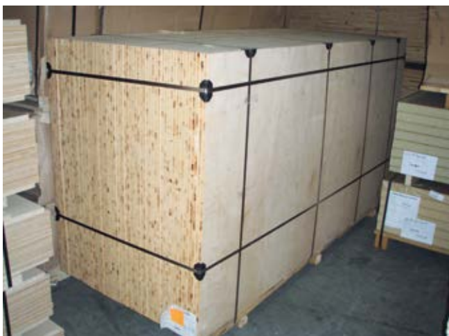
Abb. 10-35 Mit Umreifungsbändern paketierte Ladeinheiten
