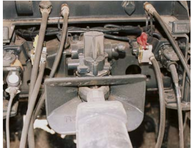
Abb. 2-31 Detailaufnahme einer Bolzenkupplung
