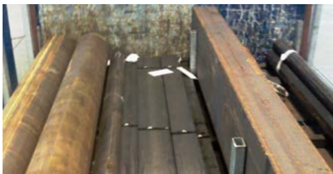
Abb. 10-92 Formschluss in Fahrtrichtung
