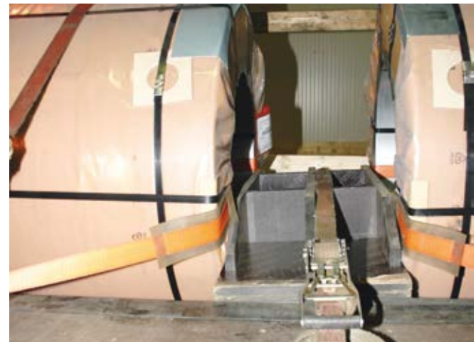
Abb. 10-66 Muldenabdeckbretter als Abstandhalter und Gurte mit Kantenschutz
