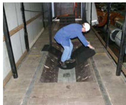
Abb. 7-43 / 7-44 Der Einsatz von rutschhemmenden Materialien, z. B. Antirutschmatten mit einem Reibbeiwert von \mu = 0,6 auf einer besenreinen Ladefläche, wird als Basis der Ladungssicherung allgemein anerkannt.
