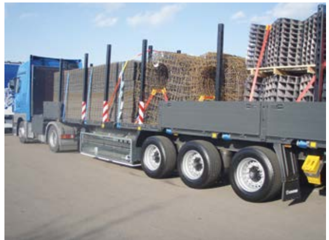
Abb. 10-76 Kombination aus Formschluss und Niederzurren
