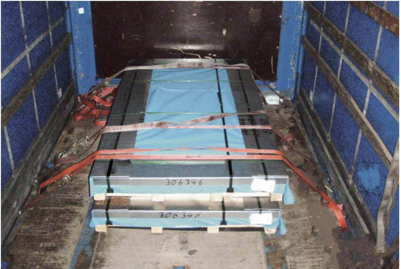
Abb. 10-96 Formschluss in Fahrtrichtung durch die Stirnwand
