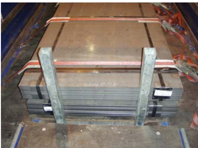
Abb. 10-26 Blockieren durch Steckungen
