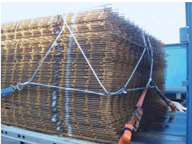
Abb. 10-75 Direktzurren mit speziellem Drahtseilsystem
