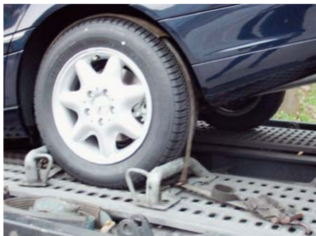
Abb. 10-109 Richtige Position für Drei-Punkt-Zurrgurt
