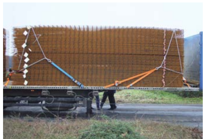
Abb. 10-79 Direktzurren durch Drahtseilssysteme
