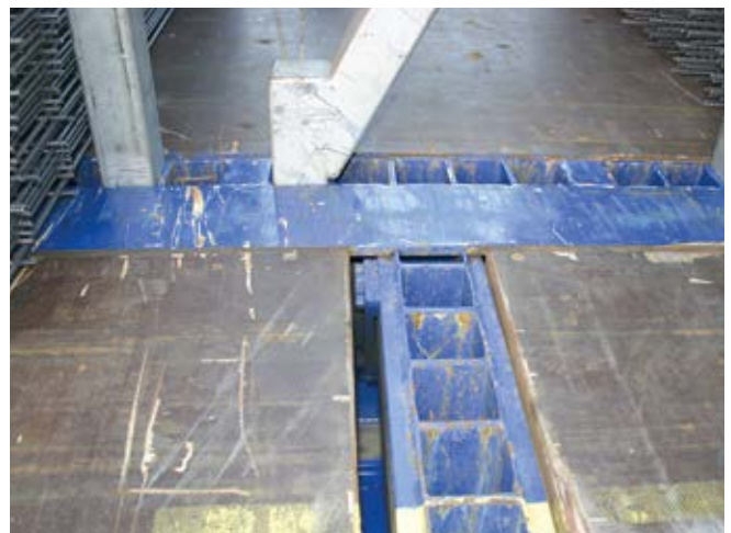
Abb. 6-59 Steckungen können in Rungenaufnahmen eingesetzt werden.
