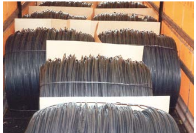
Abb. 10-86 Unpalettiert mit waagerechter Wickelachse; muss noch gegurtet werden!
