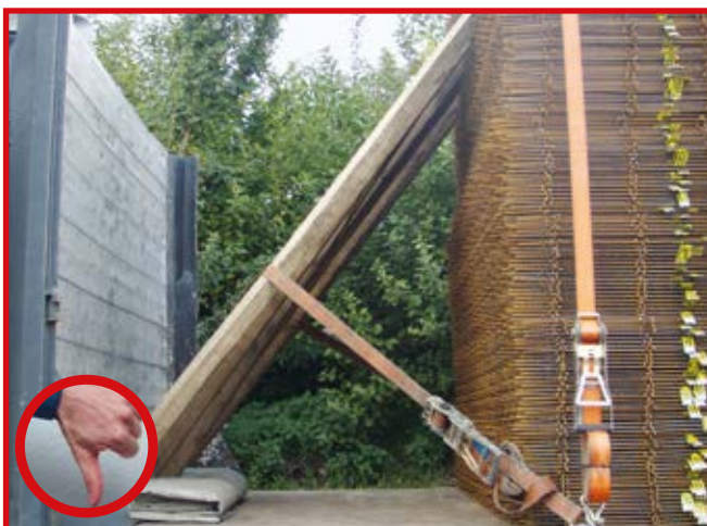
Abb. 10-78 Kein Formschluss auf diese Weise
