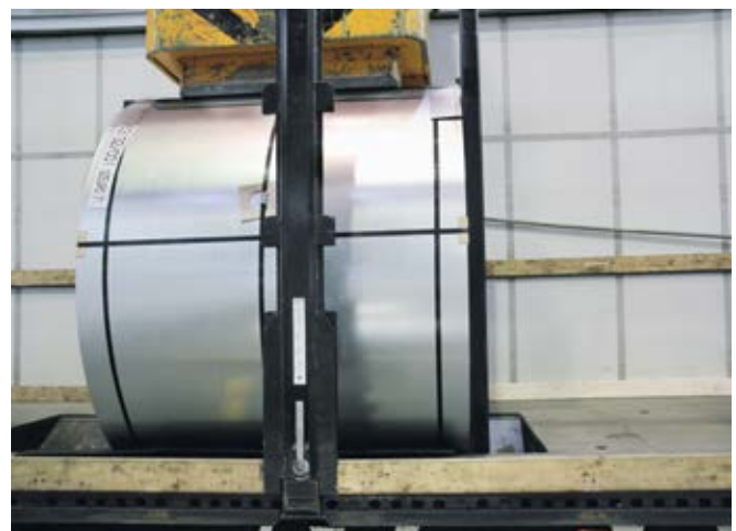
Abb. 10-65 Positionieren eines Coils gegen Steckungen
