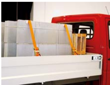
Abb. 7-41 Praxisbeispiel: Leerraletten als Hilfsmittel zum Herstellen des Formschlusses in Fahrtrichtung in Kombination mit Niederzurren
