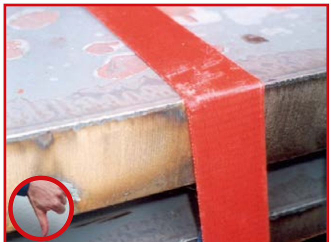
Abb. 10-73 Ohne Kantenschutz: Gurte werden zerschnitten
