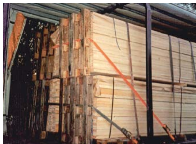
Abb. 10-45 Lösungsvorschlag: Kopfschlingen
