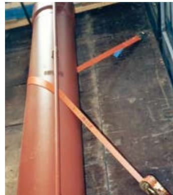
Abb. 7-38 Zur seitlichen Sicherung sind mindestens drei solcher Umreifungszurrungen erforderlich: eine zu einer Seite und zwei zur anderen Seite.
