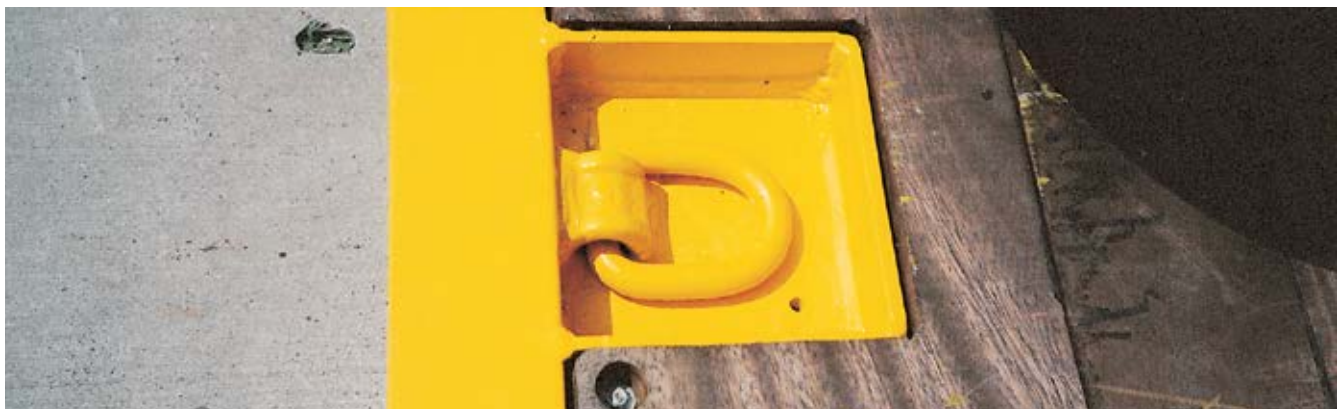
Abb. 5-25 Zurpunkte gemäß DIN EN 12640: Befestigungsvorrichtungen am Fahrzeug, an denen ein Zurrmittel direkt befestigt werden kann
