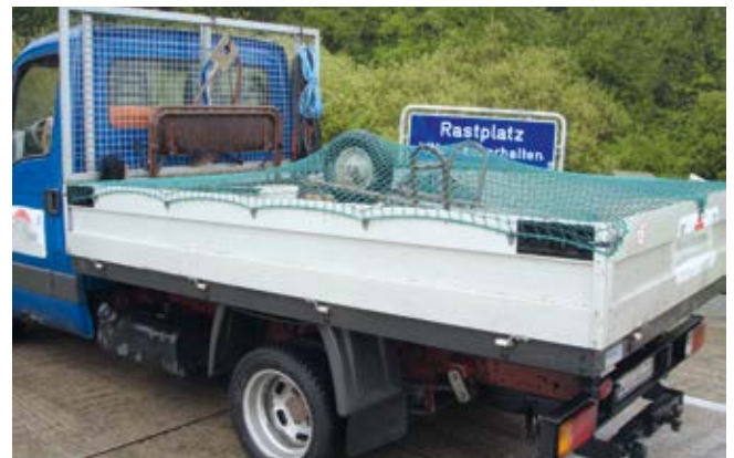
Abb. 10-13 Abdecknetz schützt andere Verkehrsteilnehmer
