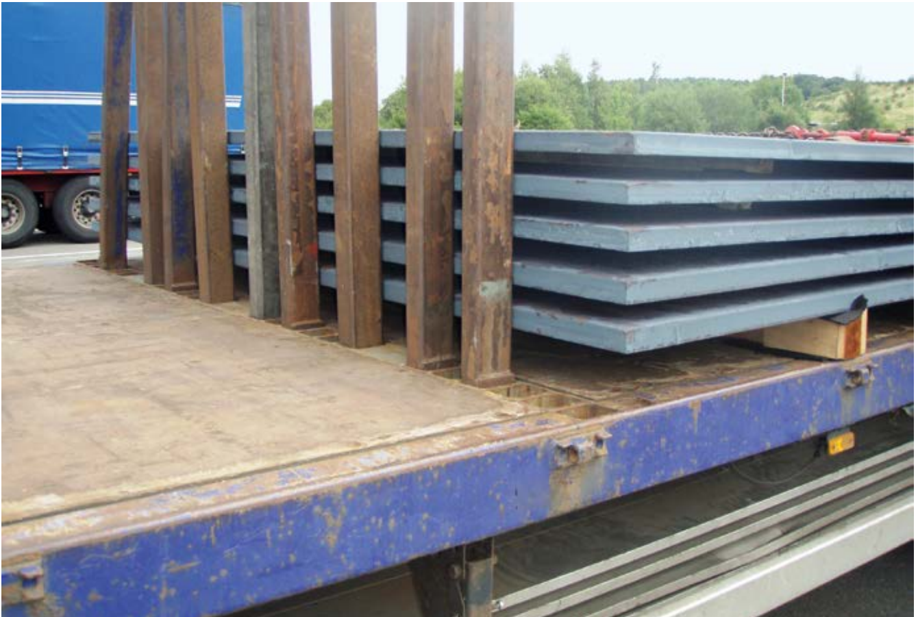
Abb. 10-67 Blockieren mit Steckungen
