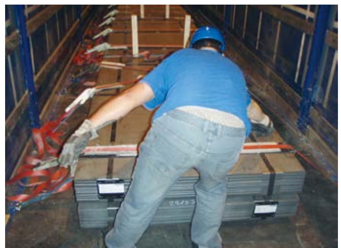
Abb. 10-27 Fixieren mit Zurrgurten
