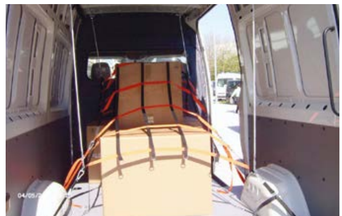
Abb. 6-39 / 6-40 Zurrnetz mit Expandersystem
